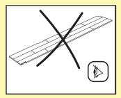
Controllare la possibilità di rimuovere i vecchi zoccoli. È possibile lasciare i battiscopa della parete al loro posto e terminare il pavimento con i profili Pergo, o coprire gli attuali battiscopa con il battiscopa a copertura Pergo.
