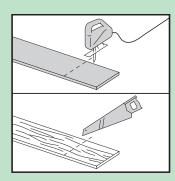
Iniziare con la prima tavola che sarà installata nell'angolo. Rimuovere il profilo a incastro sul lato lungo e sul lato corto della tavola, segandolo. Per le altre tavole della prima fila (non nell'angolo), rimuovere il profilo a incastro sul lato lungo che sarà appoggiato direttamente alla parete.
