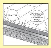
Il contenuto di umidità del sottofondo deve essere minore del 2,5% CM / 75% UR (massetto di cemento) o minore dello 0,5% CM / 50% UR (massetto di anidrite - sottofondo). Con il riscaldamento a pavimento, i risultati devono essere 1,5% CM / 60% UR e 0,3% CM / 40% UR rispettivamente. Misurare, registrare e archiviare i risultati del contenuto di umidità.
