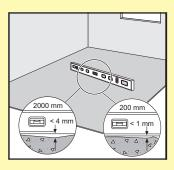
Dopo aver controllato le irregolarità del sottofondo, aspirare accuratamente l'intera superficie. Verificare che la base del pavimento sia piana, pulita, stabile e asciutta. Per evitare il rischio di cigolii, fissare tutti i pannelli in truciolato, gli OSB, le tavole in fibra, i tavolati ecc. con viti.
