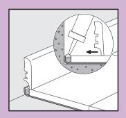
Per una finitura resistente all'acqua del profilo di modanatura 5- in -1 (PGINCP), fissare il profilo di modanatura 5-in-1 sul pavimento di base con PG Multiglue e/o con viti. Applicare PG Aqua Sealant trasparente sulla schiuma PE flessibile che si trova nel giunto di dilatazione. Spingere il profilo di modanatura 5-in-1 nel profilo base e nel PG Aqua Sealant ancora fresco.
