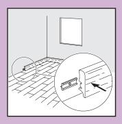
Nel segare i pannelli, verificare che il giunto di dilatazione sotto la porta sia almeno di 10 mm. Se non è possibile sollevare il pannello, utilizzare il blocco di battuta o la sagoma di metallo e battere leggermente i pannelli insieme con il martello quando le tavole sono appiattite sul pavimento.
