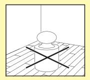
La pavimentazione in laminato Pergo è destinata a essere installata come pavimento flottante, per consentire la naturale espansione e contrazione dovuta al cambio di temperatura e umidità. Per ottenere i benefici del pavimento flottante ed evitare possibili vuoti, cigolii, ecc, non fissare mai il pavimento con chiodi, viti, silicone, ecc.
