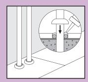
Per assicurare una maggiore protezione all'acqua intorno al perimetro del pavimento e per evitare che l'acqua penetri sotto i pannelli, applicare PG Aqua Sealant flessibile fino alla base della parete, sulle soglie, sui telai delle porte, sulle coperture de tubi, ecc.
