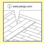
Installare il nuovo pavimento a un'angolazione di novanta gradi rispetto al sottofondo esistente. Il vespaio sottostante il pavimento in tavole dovrà essere adeguatamente ventilato.
