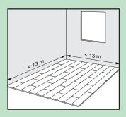
L'umidità ambiente varia a seconda delle stagioni, quindi è vitale che il pavimento possa espandersi e contrarsi. A questo scopo verificare di aver lasciato un giunto di dilatazione da 8 a 10 mm (da 5/16" a 3/8") su tutti i lati del pavimento, attorno a tubi, alle soglie e sotto le porte.
